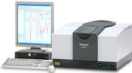
Gambar 5. Instrumen FTIR untuk karakterisasi film
