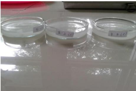
Gambar 3. Pembuatan film KPE kitosan-alginat-eugenol menggunakan cawan petri
