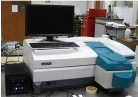
Gambar 9. Contoh instrumen UV-Vis dalam pengujian film (sumber: <https://www.kimiapost.net/>)
