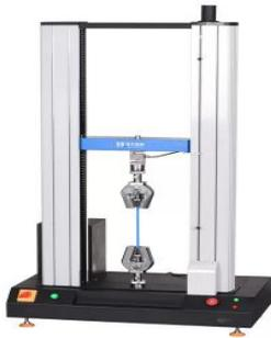
Gambar 7. Contoh alat pengujian *tensile strength*/kuat tarik suatu film (sumber: [www.http://indonesian.labtestmachines.com](http://indonesian.labtestmachines.com))
