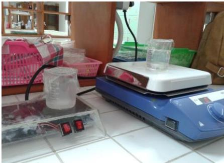
Gambar 1. Proses pembuatan larutan KPE kitosan alginat
