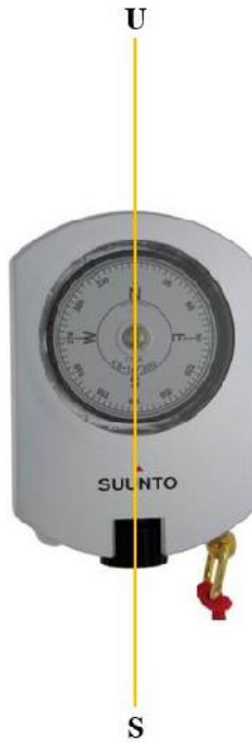
Gambar 61 Membuat Titik Utara-Selatan
