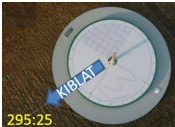
Gambar 54 Pemindahan Benang ke Posisi Kiblat
