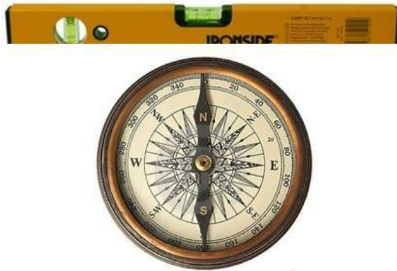
Gambar 38 Meratakan Posisi Kompas Menggunakan Waterpass
