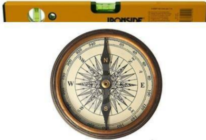
Gambar 38 Meratakan Posisi Kompas Menggunakan Waterpass
