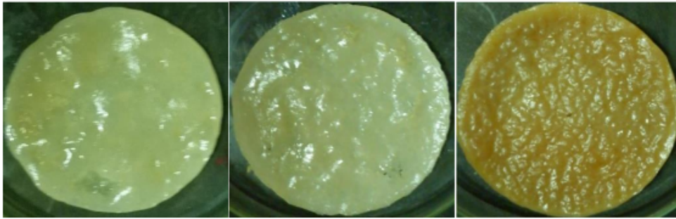
Gambar 2. Selulosa bakteri dengan medium sari buah nanas standar produksi air kelapa, A. strain GDN 32, B. strain SLK 1, dan C. strain MGA 6.
