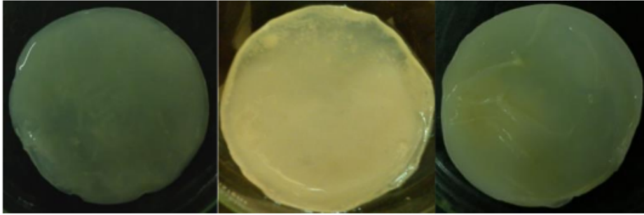
Gambar 6. Selulosa bakteri dengan medium sukrosa standar HS (Hestrin & Schramm), A. strain GDN 32, B. strain SLK 1, dan C. strain MGA 6.
